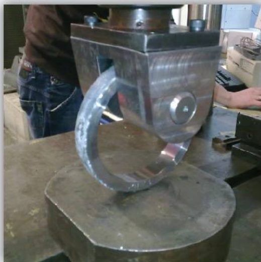
Рисунок 2: Модуль для испытания на сжатие устанавливается в 10К машину для испытания на растяжение
