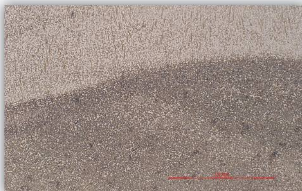
Граница проплавления между OTW 12Ti и OTW 16XS сверху.
