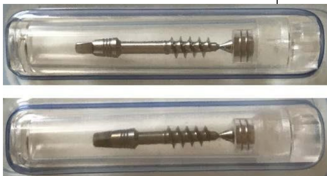
Рис. 2. Имплантат без покрытия (сверху) и с покрытием (внизу)
