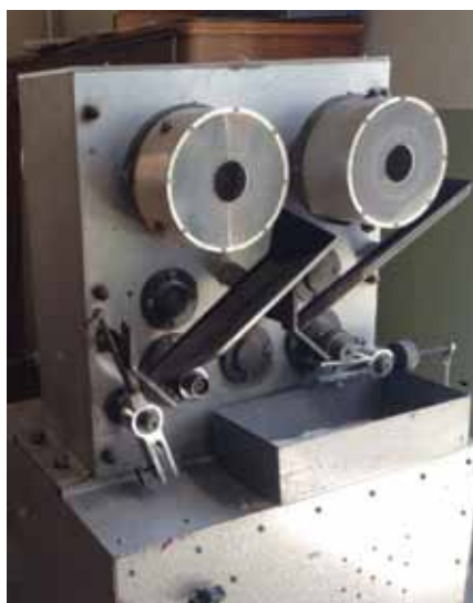
Рис.3. Общий вид испытательного стенда, выполненного по ГОСТ 23.208-79.
