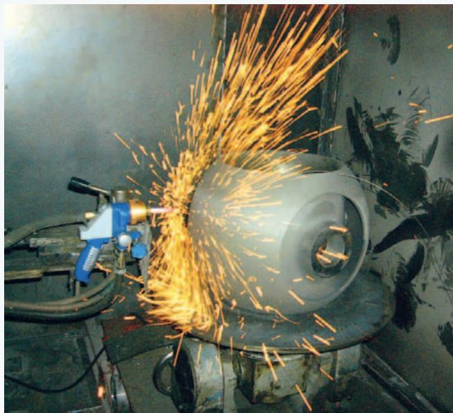
Напыление на пробку затвора
