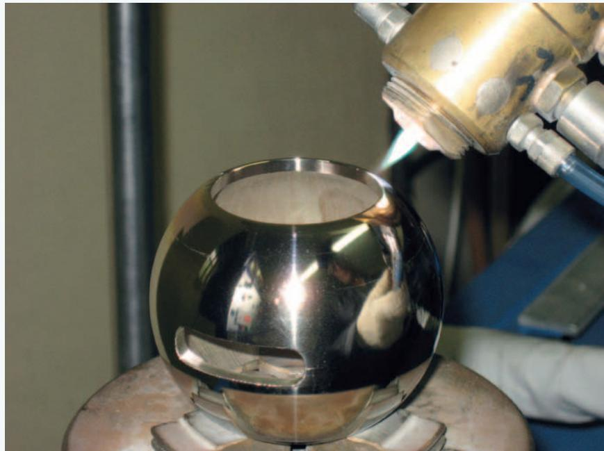
Осаждение покрытия на пробку
