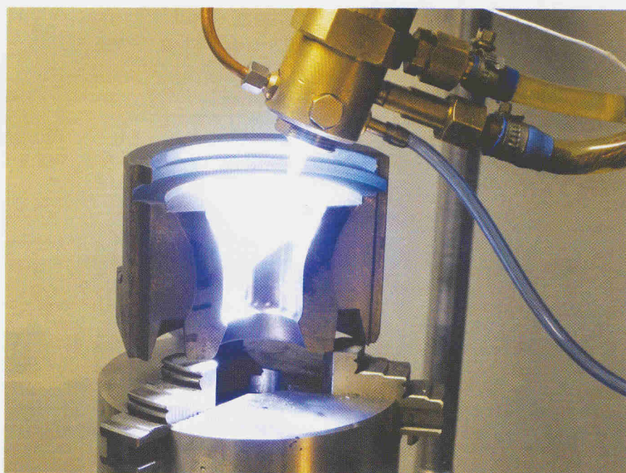
Рис. 5. Нанесение алмазоподобного покрытия на детали формокомплекта в ООО «ТД «Азовстекло»
