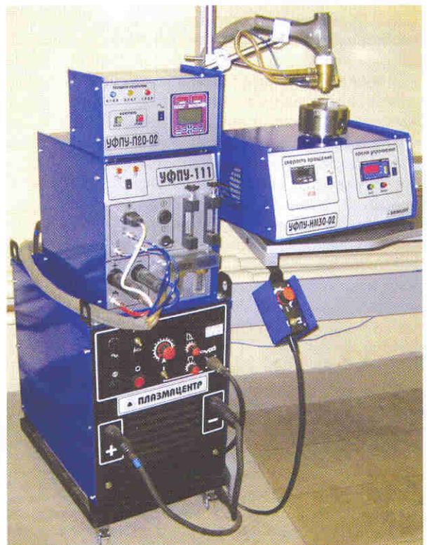
Рис. 4. Установка для финишного плазменного упрочнения с нанесением алмазоподобного покрытия
